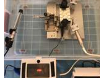
Şekil 1. Döngüsel yorgunluk direnci test düzeneği
