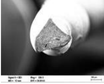
Şekil 3. 2Shape eğesinin kırık yüzeyinin taramalı elektron mikroskobu görüntüsü
